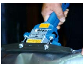
Sellado hermético de colchones (bolsas termoselladas). (Fotografías Rentokil-España)
