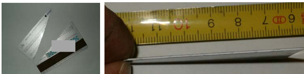
Útil casero de ayuda a la inspección – tratamiento; se trata de una tarjeta de crédito (o material análogo) desechada y cortada y puede ser utilizada para explorar grietas y refugios potencialmente infestados. (Fotografías UTCV-Madrid Salud)
